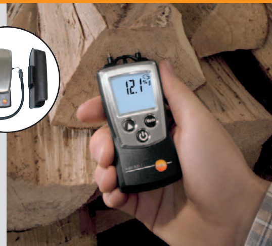
Überprüfung der Holzfeuchte
