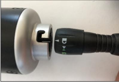
Verbinden Sie die Buchse des Kamerakabels mit dem Bajonett-Stecker am Kamerakopf.
