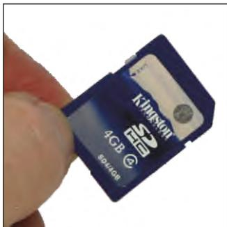
Schieben sie die SD-Karte über den Widerstand hinaus mit der Schrift nach unten in den Kartenschlitz, bis ein Klicken zu hören ist. Jetzt ist die Karte arretiert und einsatzbereit.
