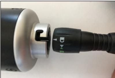
Der Stecker am Kamerakopf wird gleichermaßen angeschlossen. Bitte beachten Sie, dass die Kamera erst in Betrieb genommen werden kann, wenn sämtliche Verbindungen des Systems hergestellt sind und das Grundgerät eingeschaltet ist. Sobald dies erfolgt ist, leuchtet die im Inneren des Kamerakopfes integrierte Beleuchtung.
