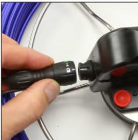
Zum Verbinden den Pfeil der Bajonettbuchse mit der Linie am Bajonettstecker überein bringen. Nur so kann die Verbindung hergestellt werden. An das Ende der GFK-Stange wird nun der Kamerakopf montiert.
