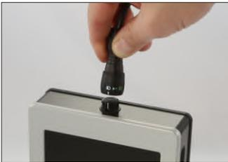
**Der Monitor muss zum Laden ausgeschaltet sein.** Schalten Sie das Gerät mit dem roten Ein-/Aus-Taster aus. Verbinden Sie den Stecker des Ladegerätes mit der Buchse an der Sie auch die Haspel, bzw. das Kabel anschließen. Stecken Sie den Netzstecker des Ladegerätes in die 230 V Steckdose.
