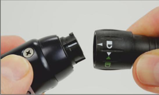
Verbinden Sie die Buchse des Kamerakabels bzw. der Kamerastange mit dem Bajonett-Stecker am Kamerakopf der MK28. Der weiße Pfeil am Stecker muss mit der weißen Linie der Buchse voreinander liegen. Dann zusammenschieben und den Stecker durch eine viertel Drehung im Uhrzeigersinn verriegeln.
