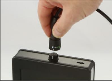
Verbinden Sie den Schnellverschlussstecker des Kabels mit der Buchse am Monitor. Stecker und Buchse passen zusammen, wenn Sie den weißen Pfeil mit dem offenen Schloss über den weißen Strich des Steckers halten und zusammen schieben. Verriegelt wird mit einer viertel Drehung im Uhrzeigersinn. Gelöst wird die Verbindung wieder entgegengesetzt.
