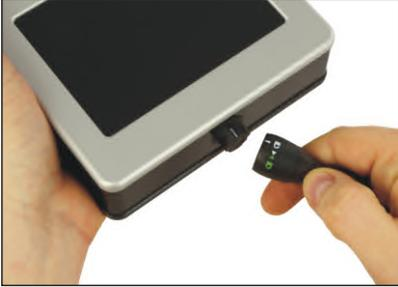
Verbinden Sie den Bajonettstecker des Kabels mit der Buchse am Monitor. Stecker und Buchse passen zusammen, wenn Sie den weißen Pfeil mit dem offenen Schloss über den weißen Strich des Steckers halten und zusammen schieben. Verriegelt wird mit einer viertel Drehung gegen den Uhrzeigersinn. Gelöst wird die Verbindung wieder im Uhrzeigersinn.
