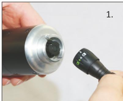
Verbinden Sie zuerst den Stecker des Kamerakabels mit der Buchse vom Kamerakopf. Der weiße Pfeil am Stecker muss mit der weißen Linie der Buchse voreinander liegen. Dann den Stecker durch eine viertel Drehung im Uhrzeigersinn verriegeln. Der Kamerakopf soll erst eingeschaltet werden, wenn alle Kabel angeschlossen sind. Die Steuerung der Drehkugelkamera erfolgt durch die Pfeiltasten auf dem Tastenpaneel.
