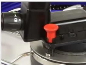
Die Haspel ist mit einer Sicherung ausgestattet, damit die Stange nicht selbstständig herausläuft. Um den Korb zu entriegeln, den roten Knopf nach oben ziehen und zum Arretieren eine viertel Drehung drehen.
