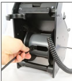
Ziehen Sie den Stecker aus dem inneren des Kerns heraus und fixieren ihn auf der linken Seite im schmalen Auslass (vgl. Foto). Nun können Sie den Bajonett-stecker des Kamerakabels anschließen. Das angeschlossene Kabel muss nun nach rechts aus der Fixierung geschoben und in das innere des Kerns gelegt werden. Jetzt können Sie das Kamerakabel auf die Trommel aufwickeln.
