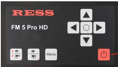
Mit dem Ein-/Ausschalter wird das Gerät eingeschaltet
