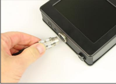
Verbinden Sie den 8-poligen Stecker des Kabels mit der Buchse am Monitor. Schrauben Sie die Verbindung handfest.
