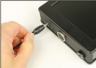
Der Monitor kann sowohl über den Akku, als auch über das Netz-Ladegerät betrieben werden. Wenn das Ladegerät angeschlossen ist, steht vor der Prozentanzeige ein „L“. Das Gerät kann verwendet werden und der Akku wird parallel aufgeladen. Die Kontroll-LED leuchtet rot. Bei vollem Akku schaltet Sie auf grün.
