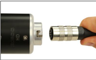
Verbinden Sie die 8-polige Buchse des Kamerakabels mit dem 8-poligen Stecker am Kamerakopf. Der Monitor startet nur wenn ein Kamerakopf angeschlossen ist.
