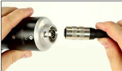
Verbinden Sie die Buchse des Kamerakabels mit dem Stecker am Kamerakopf. Drehen Sie die Verschraubung handfest. Den Monitor erst einschalten, wenn alles angeschlossen ist. Das System muss komplett gestartet werden, sonst gibt es kein Bildsignal.
