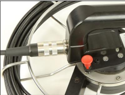
Stecken Sie Buchse und Stecker gerade zusammen und schrauben die Verbindung handfest.
