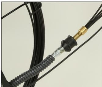
Schrauben Sie die Haspelanbindung mit dem M10 Gewinde an die Haspel oder Stange an.
