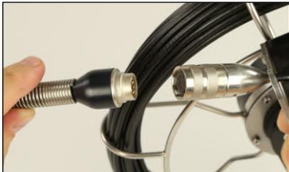
Verbinden Sie die Buchse der Kamerastange (bzw. des Kabels) mit dem Stecker des Kamerakopfes. Drehen Sie die Verschraubung handfest. Den Monitor erst einschalten, wenn alles angeschlossen ist. Das System muss komplett gestartet werden, sonst gibt es kein Bildsignal.
