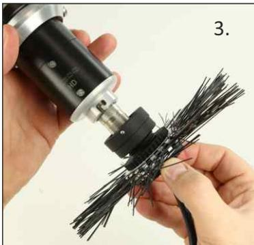
Den Stecker des Kamerakabels zuerst an den Kamerakopf anschrauben und dann das Oberteil der Verschraubung in die Nut einführen. Erst jetzt das Unterteil festschrauben und darauf achten, dass die Splinte dabei verriegeln.
