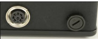
Neben der Buchse auf der Stirnseite befindet sich eine Verschraubung hinter der sich eine Sicherung befindet. Diese dient zur Absicherung des Li-Ion-Akkus. Wird sie entfernt, trennt man dadurch den Akku von der Elektronik. Dieses ist sinnvoll, wenn Sie einen Servicefall haben sollten.
