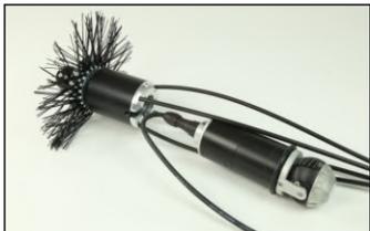
Die Drehkugelkamera muss in die Alu-Hülse der Haspelanbindung hinein geschoben werden. Das Kabel durch den Kabelschlitz führen und die Nuten an den Splinten fest arretieren.
