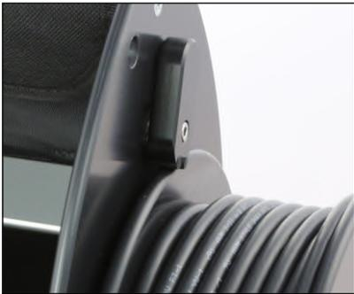
Die Feststellbremse klemmt die Kabelrolle fest, um ein selbstständiges Abdrehen des Kabels während einer Inspektion oder beim Transport des Gerätes zu verhindern. Betätigen Sie die Feststellbremse an der Kabelrolle immer bevor Sie das Kabel bei der Inspektion loslassen.
