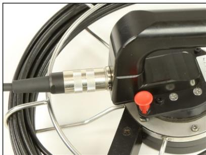
Collegare anche la presa e il connettore sul manico in modo uniforme e avvitarla la connessione a mano fino a fissarla saldamente.
