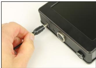
Il monitor può funzionare sia a batteria che tramite l'alimentatore. Quando è collegato, davanti all'indicazione percentuale appare una "L". Il dispositivo può essere utilizzato e la batteria viene caricata parallelamente. La LED di controllo si accende di rosso. Quando la batteria è completamente carica, si spegne e diventa verde.
