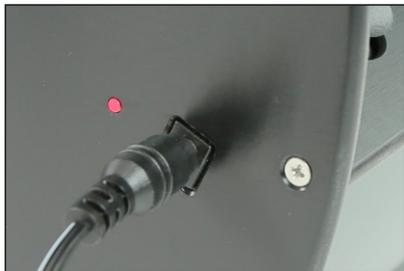
Al momento della consegna del sistema della telecamera, la batteria non è completamente carica. La telecamera di ispezione deve essere prima ricaricata. Le informazioni sulla spia di controllo della ricarica a LED si trovano a pagina 10.
