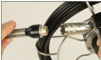
Alla presa dell'asta in GFK viene montata la testa della telecamera. Assicurarsi che entrambe le filettature siano allineate, altrimenti si danneggerà il filetto fine.
