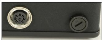
Accanto alla presa sulla parte frontale si trova una vite dietro la quale si trova un fusibile. Questo serve a proteggere la batteria Li-Ion. Se viene rimossa, si disconnette la batteria dall'elettronica. Questo è utile nel caso si debba effettuare un intervento di assistenza.
