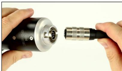
Collegare la presa del cavo della telecamera al connettore sulla testa della telecamera. Avvitare la connessione a mano fino a fissarla saldamente. Accendere il monitor solo quando tutto è collegato. Il sistema deve essere avviato completamente, altrimenti non ci sarà segnale video. Il controllo della telecamera a sfera rotante avviene sul monitor FM5 Pro utilizzando i tasti freccia. La SK7 ha un controllo joystick.
