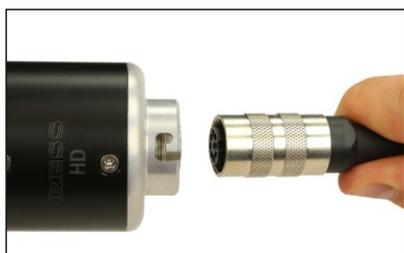
Collegare la presa a 8 poli all'altro capo del cavo della telecamera con la testa della telecamera. Il monitor si avvia solo se è collegata una testa della telecamera.
