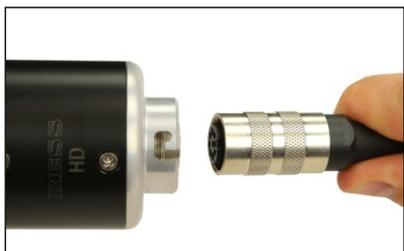
Collegare la presa a 8 poli del cavo della telecamera con il connettore a 8 poli sulla testa della telecamera. Il monitor si accende solo se è collegata una testa.
