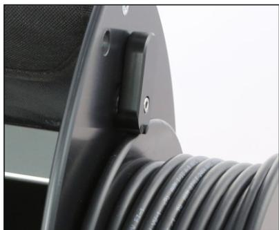
Il freno arresta il tamburo del cavo, per evitare che il cavo si srotoli da solo durante un'ispezione o il trasporto dell'apparecchio. Azionare sempre il freno al tamburo del cavo, prima di lasciare andare il cavo per l'ispezione.
