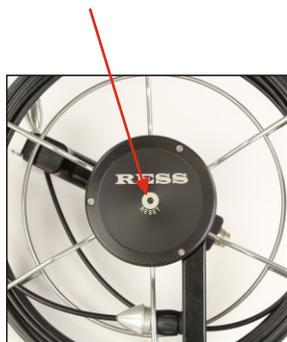
L'aspo possiede un contametri digitale, visualizzato sul display. È possibile azzerare in qualsiasi momento il valore durante l'ispezione premendo il campo di reset: è utile se si desidera svolgere una misurazione relativa. È possibile in entrambe le direzioni.
