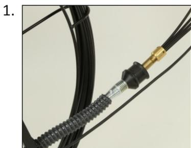
Avvitare la guida testata con filettatura M10 all'asta.
