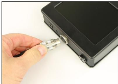
Collegare il connettore a 8 poli del cavo alla presa del monitor. Avvitare il collegamento a mano fino a fissarlo saldamente.
