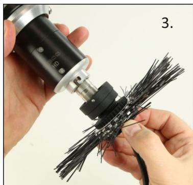
Prima avvitare il connettore del cavo alla testa, poi inserire la parte superiore della vite di fissaggio nella scanalatura. Solo a questo punto serrare la parte inferiore, assicurandosi che le spine si blocchino correttamente.
