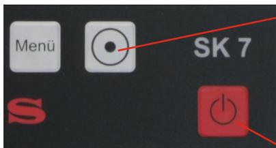
1. Il valore del contametri digitale può essere azzerato manualmente in qualsiasi momento durante l'ispezione. Premendo il tasto zero, il contatore torna allo zero.
