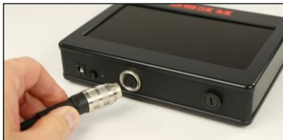
Collegare il connettore a 8 poli del cavo alla presa del monitor. Avvitare il collegamento a mano fino a fissarlo saldamente.
