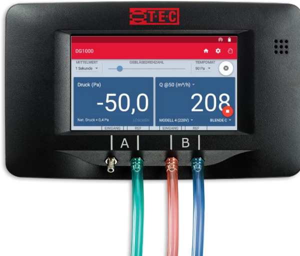
Abb. 4.28: Anschluss der Schläuche an das DG-1000
