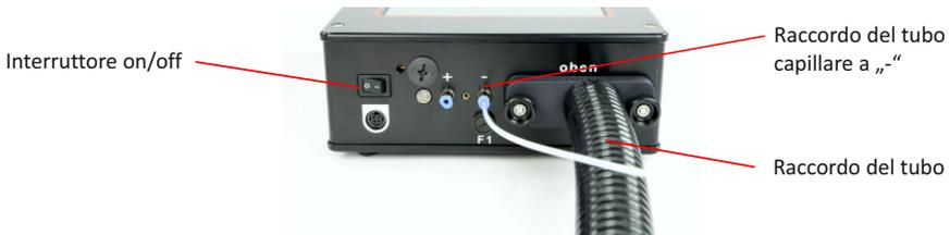
Il tubo capillare deve prima essere inserito attraverso la guarnizione e poi il tubo. È importante che il tubo capillare venga fissato ad almeno 5 cm dietro l'estremità del tubo. Inserire ora la guarnizione nel raccordo del forno o nella porta del camino.
