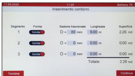
Dopo l'inserimento delle dimensioni del tubo, premere il tasto "Avanti" per avviare la misurazione. Viene eseguito un'autodiagnosi del dispositivo e la calibrazione. Successivamente appare il menu di misurazione. Dopo che è stata creata la pressione di prova, entro 1 minuto parte la misurazione e al termine viene visualizzato il risultato come valore medio.
