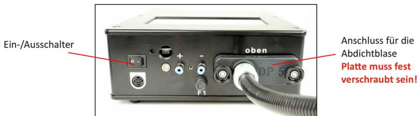
**Hinweis:** Falls möglich mit dem Messgerät die Messung vom Dach vornehmen, um Wassereinbruch im Gerät zu vermeiden.
