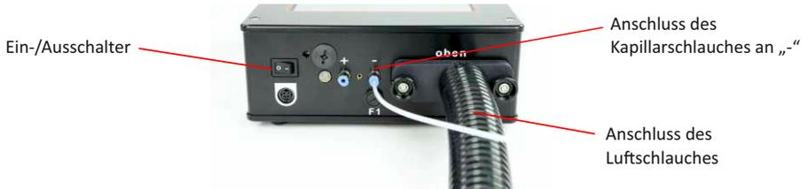
Der Kapillarschlauch wird zuerst durch das Abdichtelement geführt, danach der Luftschlauch. Wichtig ist, dass der Kapillarschlauch mindestens 5 cm hinter dem Schlauchende fixiert wird. Das Abdichtelement wird nun in das Ofenanschlusstück oder die Kamintüre eingesetzt.
