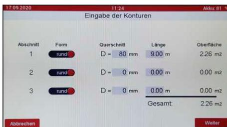
Nach Eingabe der Leitungsabmessungen muss die „Weiter“-Taste zum Start der Messung gedrückt werden. Es erfolgt ein Selbsttest des Gerätes und die Kalibrierung. Dann erscheint das Messmenü. Nachdem der Prüfdruck aufgebaut wurde, startet die Messung über den Zeitraum von 1 Minute und zeigt am Ende das Ergebnis als Mittelwert an.
